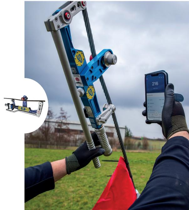
Straightpoint COLT ist ein Drahtseilspannungsmesser mit geringem Gewicht, der einfach in der Handhabung ist. Er ermöglicht ein schnelles und genaues Messen von Spannungen bis zu 5000 kg an einem Drahtseildurchmesser bis 25 mm.
