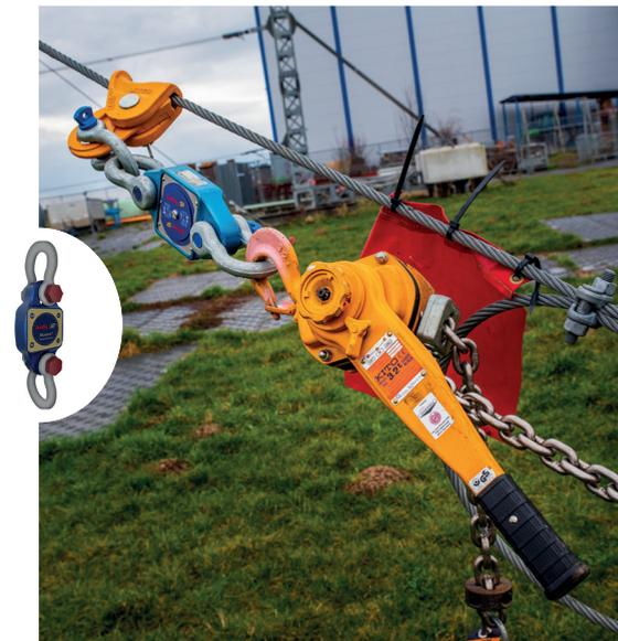
Die Kranwaage „BlueLink“ mit drahtloser Bluetooth-Technik und einer Kapazität von 6.500 kg ist für den Ersatz von älteren mechanischen Produkten vorgesehen.
